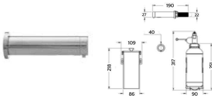
**Dosificador de jabón tubular electrónico a pared para lavabo**
