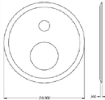
**Cubierta redonda con desviador latón**
