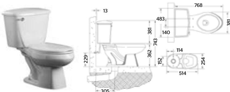
**Sanitario con tanque asistido por presión**
