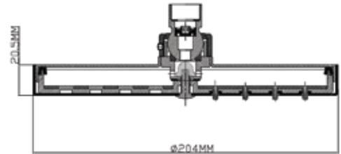
LAT131741 Cromo (CH) Cebolleta de 3" de diámetro con dos funciones. Incluye brazo y chapetón. Flujo 2.5 gpm (9.5 lts/min). Presión 0.7 kg/cm2
