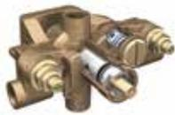
Válvula soldable de 4 puertos para regadera Moencontrol con presión balanceada y control de volumen de agua. No incluye Trim. Esta válvula utiliza el cartucho Moen mod. 1225
