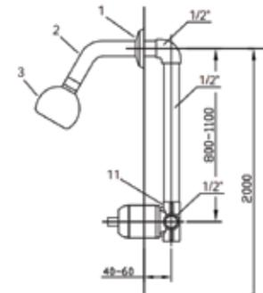
6303EP Cromo (CH) Cebolleta Eco Performance de 3-3/8" de diámetro de una función. No incluye brazo ni chapetón. Flujo 1.75 gpm (6.65 lts/min). Presión 0.7 kg/cm2
