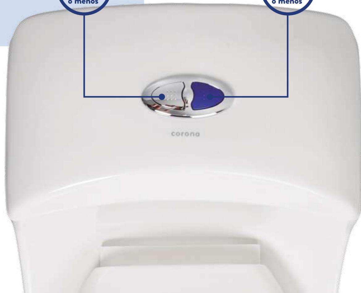
El sistema de descarga Dual Flush **Corona**, es un moderno modelo ahorrador de agua que cuenta con un sistema de accionamiento tipo push en la tapa, permitiéndole al usuario escoger entre un botón plateado para la evacuación de desperdicios sólidos, empleando una descarga máxima de 6 litros de agua, o una segunda pieza de color azul para evacuar el total de desperdicios líquidos con solo 4 litros de consumo o menos.
