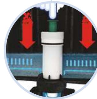
El agua contenida en el interior del cartucho es descargada cuando el botón es accionado, permitiendo que el aire llene su interior, acción por lo cual se libera el sistema de cierre, es decir; se rompe el sello. La taza se desocupa en 4 segundos; la descarga es conducida a través de un torrente de agua (turbo cargada). Una vez se abre la válvula principal el agua baja a la taza circulando por los canales que conducen al JET y al anillo de lavado.
