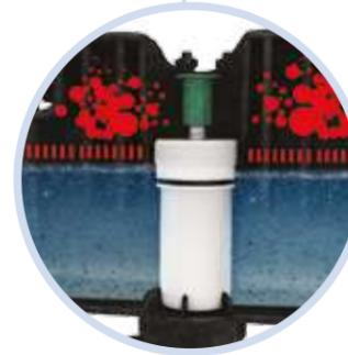
El tanque se encuentra cargado y listo para ser operado. El aire y el agua tienen igual presión. El aire contenido en el interior del tanque ejerce una presión sobre el agua.
